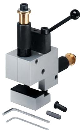
Приспособление для выполнения отверстия в дне ящика для соединения его с фасадом посредством соединителя фасада Grass.
