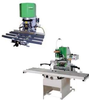
Для запрессовки дюбелей крепления фасада DWD XP 6860 с автоматом для сверления и запрессовки Ecoflex или Ecompress Vario
