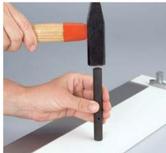
Ручное приспособление для забивания соединителя фасада с дном
